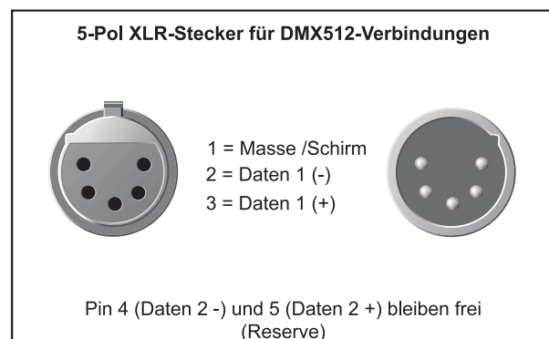
Abb. 9.1: 5-Pol XLR-Stecker für DMX512-Verbindung
